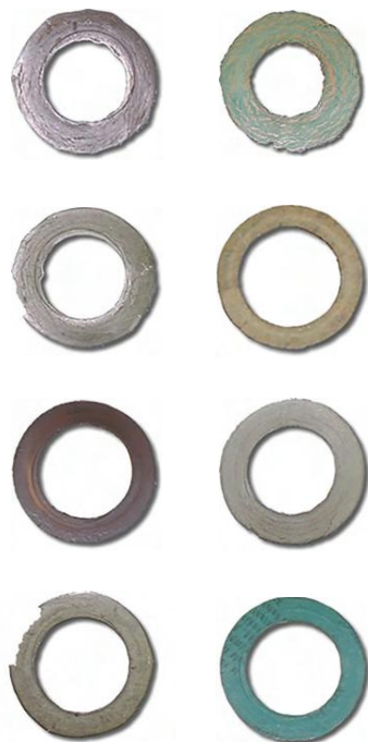
其余竞品品牌的绿色垫片在热压测试后
